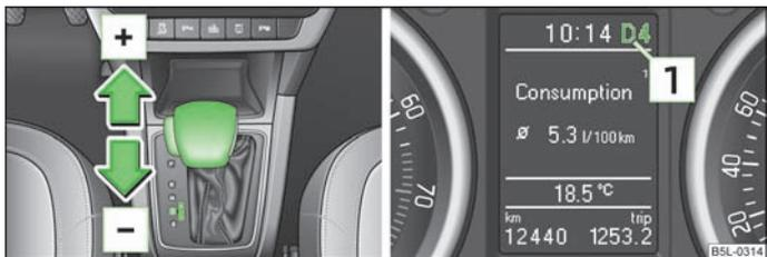
Abb. 107 Wählhebel / Informationsdisplay: Wählhebelstellungen
