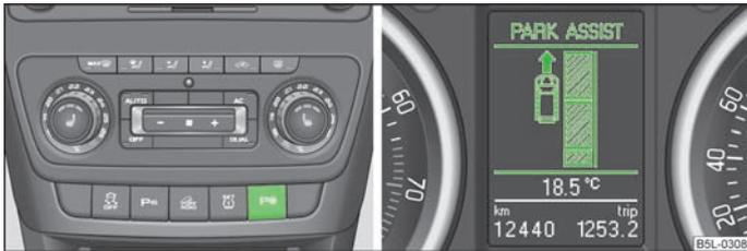
Abb. 101 Anzeige des Parklenkassistenten auf dem Informationsdisplay einschalten / Informationsdisplay: Suche nach einer geeigneten Parklücke
