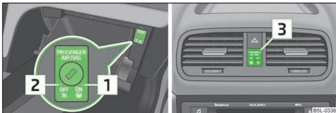
Abb. 129 Ablagefach: Schalter für Beifahrer-Frontairbag / Kontrollleuchte für Beifahrer-Frontairbagabschaltung
