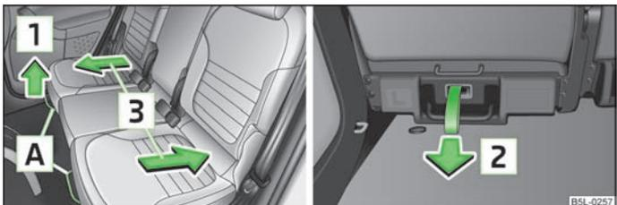
Abb. 48 Entriegelung vorn / hinten
