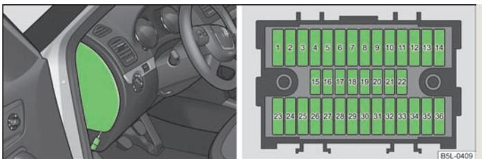
Abb. 167 Abdeckung des Sicherungskastens in der Schalttafel / Schematische Darstellung des Sicherungskastens
