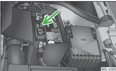
Abb. 149 Fahrzeugbatterie: Säurestandsanzeige
